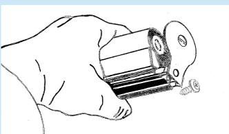
Retirez la vis retenant le couvercle d'extrémité sur le rail de montage et enlevez doucement le couvercle d'extrémité.
