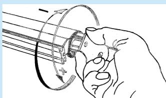
Riposizionare la nuova unità della molla lasciando la testa sporgente circa 20 mm e posizionare la staffa di back-end sul fine della molla. Ruotare la staffa in senso antiorario circa 10-14 giri seconda della larghezza della tenda.
